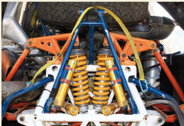
Uno de los puntos fuertes del Marathon es su sistema de amortiguación, revolucionario en los coches de su categoría y que fue diseñado y desarrollado en las instalaciones de SEAT Sport.
